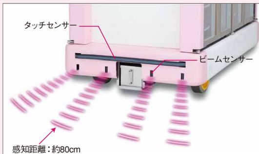
進行方向が見えづらい後退時に障害物を感じ知して停止します。障害物の約80cm手前で自動停止するビームセンサーと、障害物に接触した際に急停止するタッチセンサーを搭載しております。
